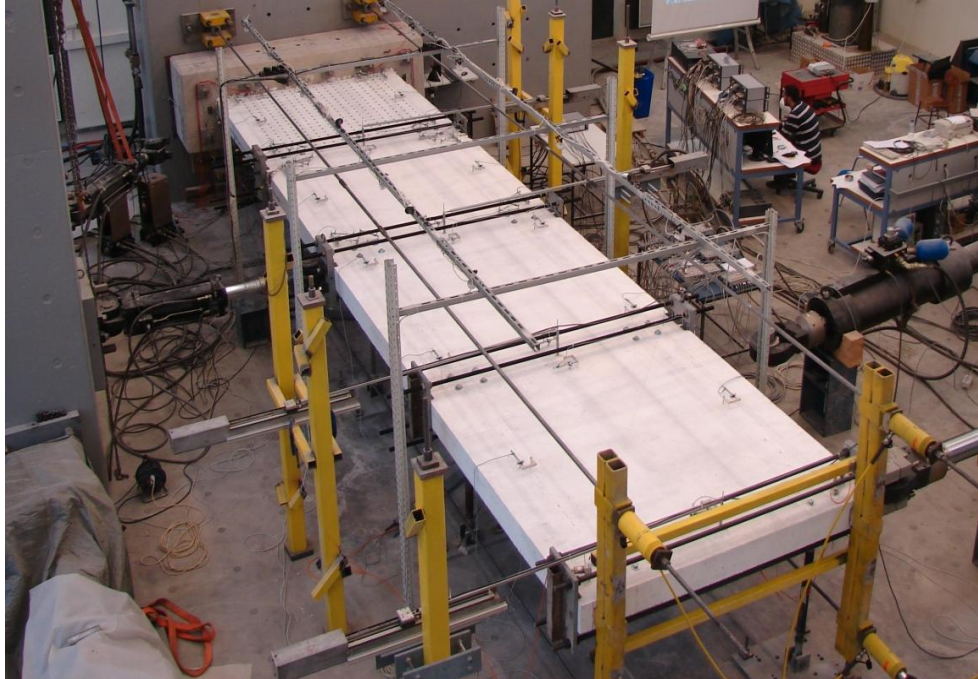
Σχήμα 102: Πειραματική διάταξη υβριδικών δοκιμών (2 βαθμών ελευθερίας).
