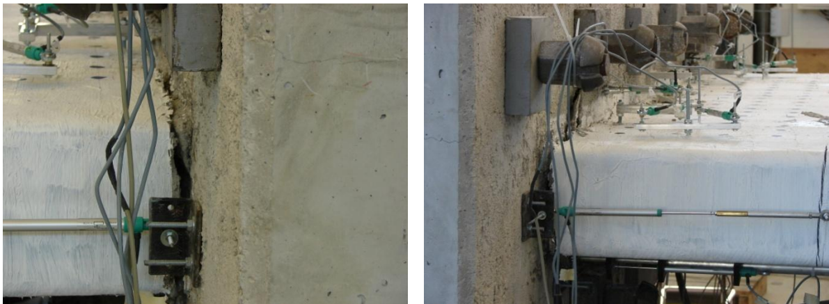
Σχήμα 130: Ρωγή στην διεπιφάνεια δοκιμίου – βάσης
