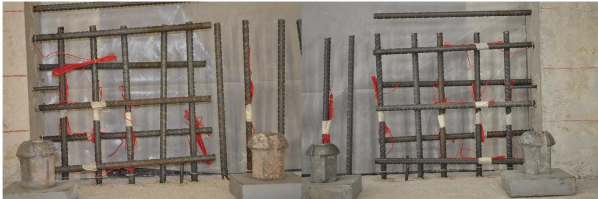
Σχήμα 155: Θέσεις ηλεκτρομηκνσιομέτρων στη Ν.Α (αριστερά) και Β.Α (δεξιά) γωνία 1ου ορόφου
