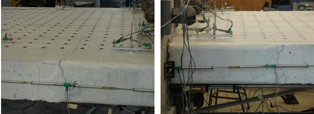
Σχήμα 105: Δημιουργία ρωγμών στο τέλος του μανδύα ινοπλισμένων πολυμερών
