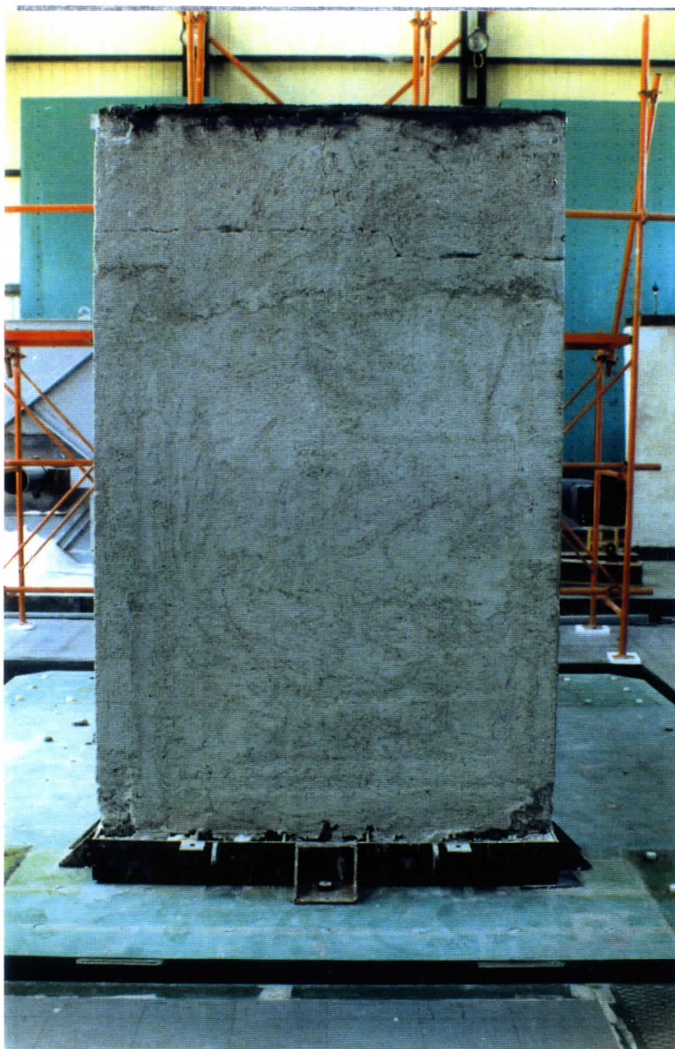
Τοίχος 9 cm χωρίς σενάζ. Θραύση των πελμάτων (LONG)
