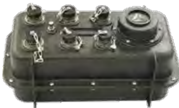
Εικόνα 4.5. Φορητός σεισμολογικός σταθμός τύπου REFTEK-132A.
