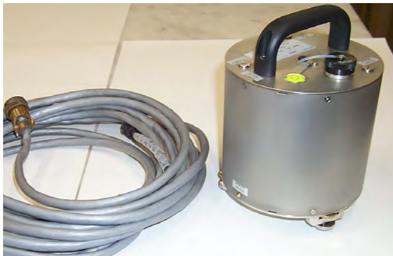
Εικόνα 4.2. Σεισμόμετρο τύπου Guralp CMG40T, που χρησιμοποιήθηκε στο πείραμα.
