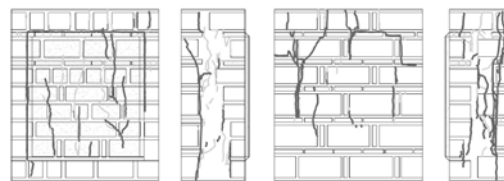
Σχ. Σ 6.18: Η Μηχανική της τριστρωτης τοιχοποιίας υπό κεντρική θλίψη.
