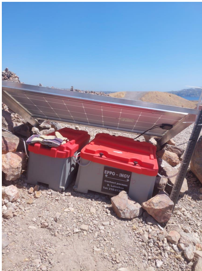
Εικόνα 4 Σταθμός μέτρησης ροής CO 2 (Νέα Καμένη)
