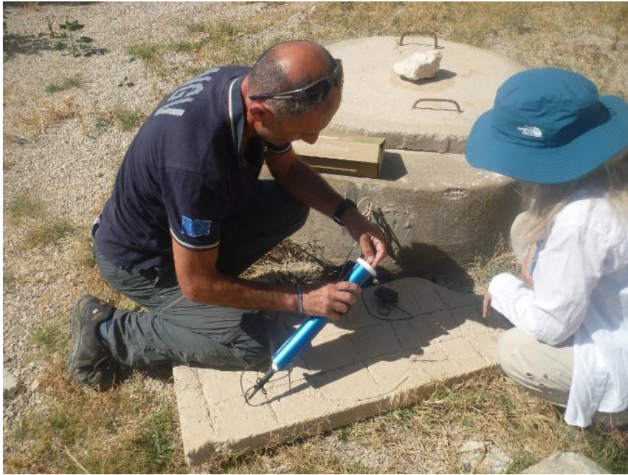
Εικόνα 9 Τοποθέτηση αισθητήρα CTD και modem κινητής τηλεφωνίας (Μονόλιθος)
