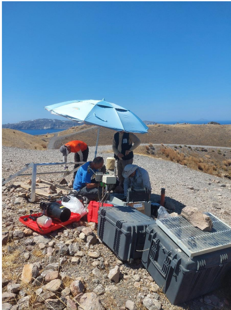
Εικόνα 1 Εργασίες εγκατάστασης σταθμού μέτρησης ροής CO 2 (Νέα Καμένη)
