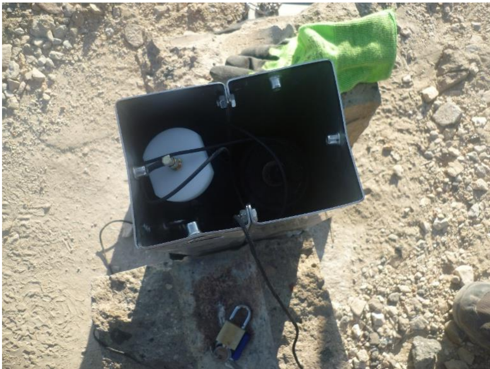
Εικόνα 6 Αισθητήρας CTD με το modem κινητής τηλεφωνίας (Εμπορείος)
