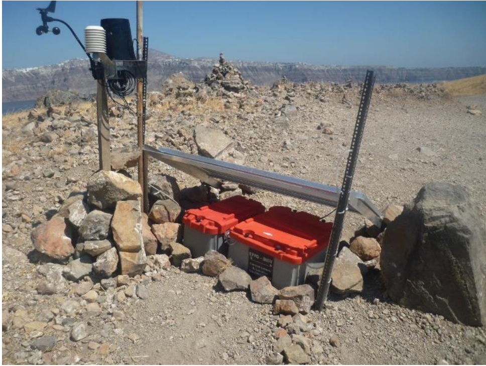
Εικόνα 5 Σταθμός μέτρησης ροής CO 2 (Νέα Καμένη)
