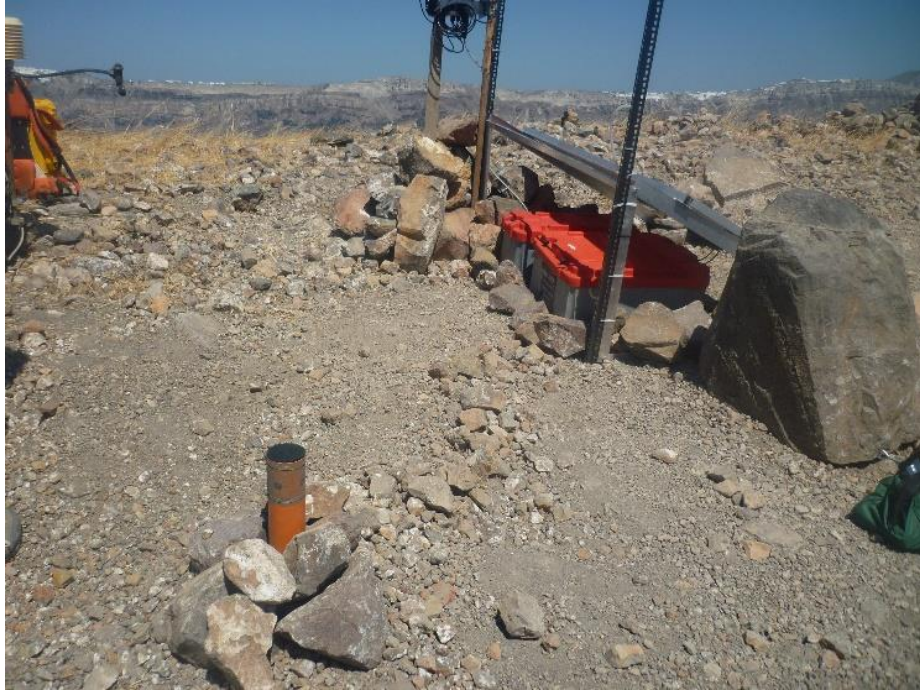
Εικόνα 3 Αισθητήρας σταθμού μέτρησης ροής CO 2 (Νέα Καμένη)
